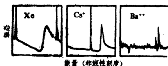
图1 等电子序列。这些序列是在自电离连续区产生的光电吸收谱。在这种比较中，能级刻度已进行了归一化。当能谱从Xe向Ba移动时，主峰的变窄表明振子强度的重新分布。（引自文献5）
