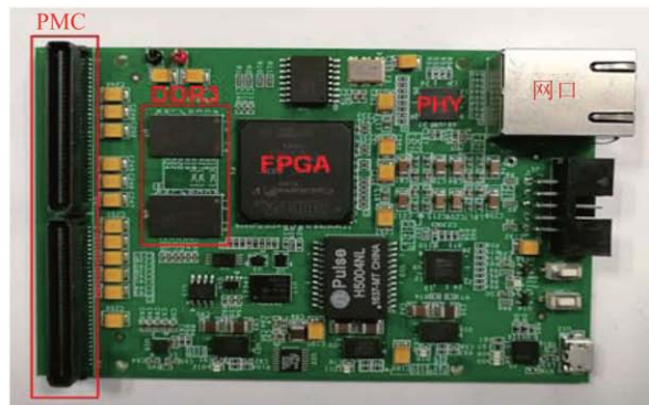
图 3 (在线彩图) SDB 硬件架构图及实物图
