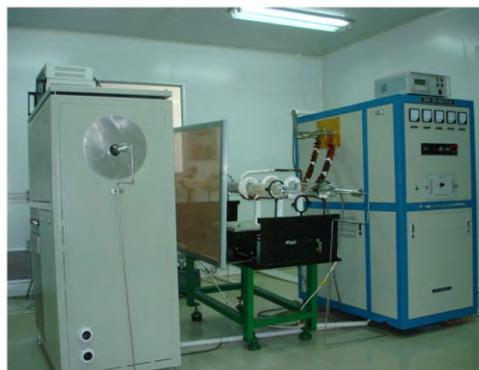
图 3 (在线彩图) 自行设计的区熔设备
