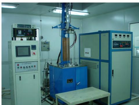
图 4 (在线彩图) 自行设计的单晶炉
