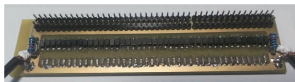
图 1 (在线彩图) 设计的 LC 延迟电路实物图
