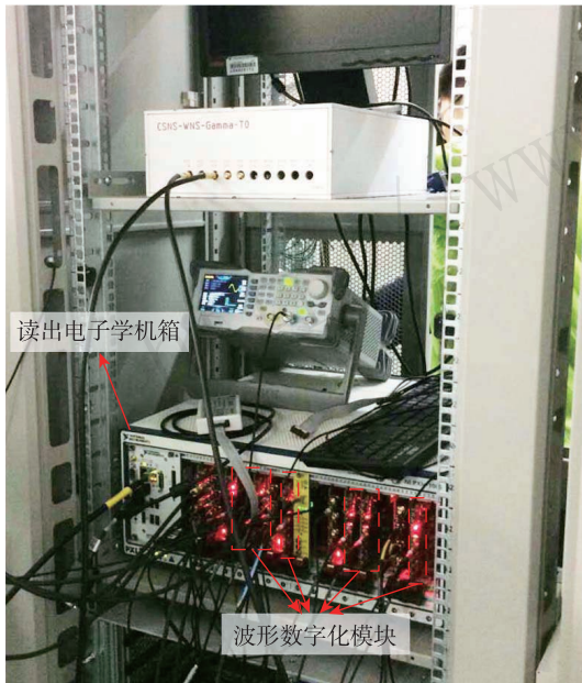
图 12 (在线彩图) 波形数字化模块物理实验现场图
