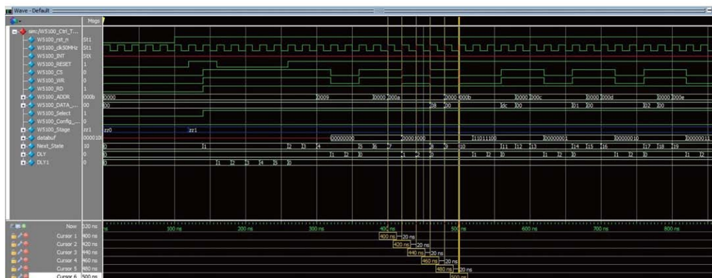
图 6 (在线彩图) W5100 初始化模块相关寄存器/存储器写入 modelsim 时序仿真图
