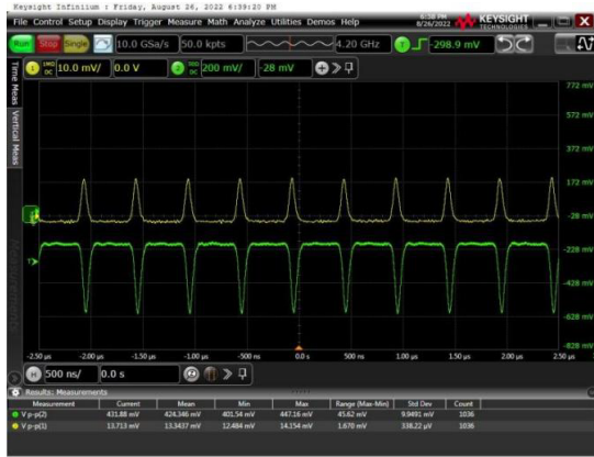
图 14 极板输入高斯信号时，相对极板的感应信号波形 (高斯信号) 以及经过高阻放大器后的信号波形 (反相高斯信号) (在线彩图)
