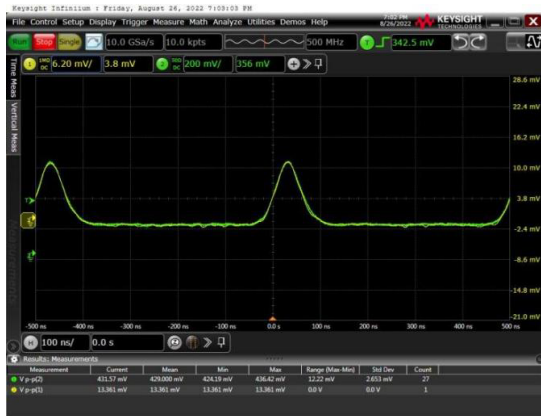
图 15 放大信号反相、时移后的波形与感应信号的波形 (在线彩图)
